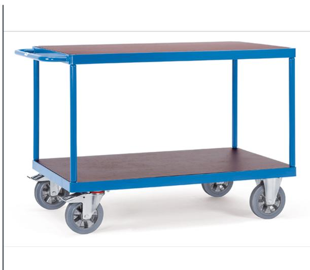
Ensemble mécano-soudé, revêtement époxy bleu RAL 5007. Plateaux en aggloméré antidérapant, plastifié et hydrofuge. Chariot spécialement conçu pour transporter des charges lourdes, les roues à bandage élastique sur jantes en aluminium avec moyeu à roulement à billes permettent un déplacement aisé et confortable. 2 roues fixes et 2 roues pivotantes à bandage caoutchouc élastique, bleu-gris non traçant. Freins sur roues pivotantes. Charge plateau du haut: 500 kg.
