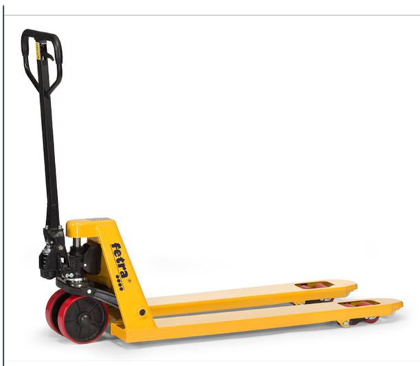
Châssis et fourches en tôle d'acier, revêtement époxy jaune. Pompe hydraulique manuelle sans entretien. Poignée habillée de caoutchouc pour: lever - rouler - descendre. Rotation: 2 x 100°. Galets en tête de fourches. Résistance au roulement faible, roulement amorti. Indiqués sur sols difficiles, non traçantes. Roulement non bruyant.
