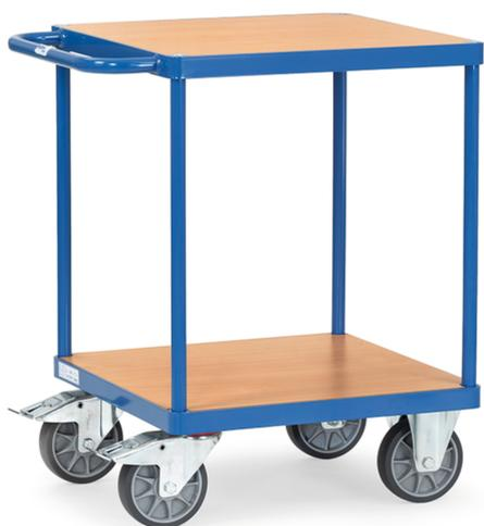
Ensemble mécano-soudé, revêtement époxy bleu RAL 5007 avec plateaux carrés 600 x 600 mm en mélaminé surface effet hêtre. Charge maximum plateau du haut: 200 kg. 2 roues pivotantes et 2 roues fixes à bandage TPE, moyeu à roulement à billes central. Freins sur roues pivotantes.
