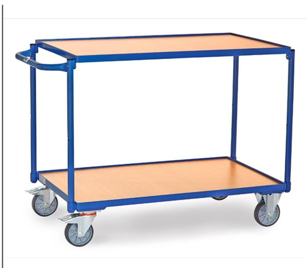
Ensemble mécano-soudé, revêtement époxy bleu RAL 5007 avec 2 plateaux en mélaminé surface effet hêtre, barre de poussée horizontale, rebord de 12 mm. Charge maximum de l'étagère haute et médiane: 80 kg. 2 roues pivotantes et 2 roues fixes à bandage TPE, moyeu à roulement à billes central. Freins sur roues pivotantes.
