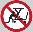
N'effectuez pas de travaux sous la plateforme de l'appareil de levage si celle-ci n'est pas verrouillée
