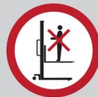
Ne montez pas sur la surface de chargement de l'appareil de levage
