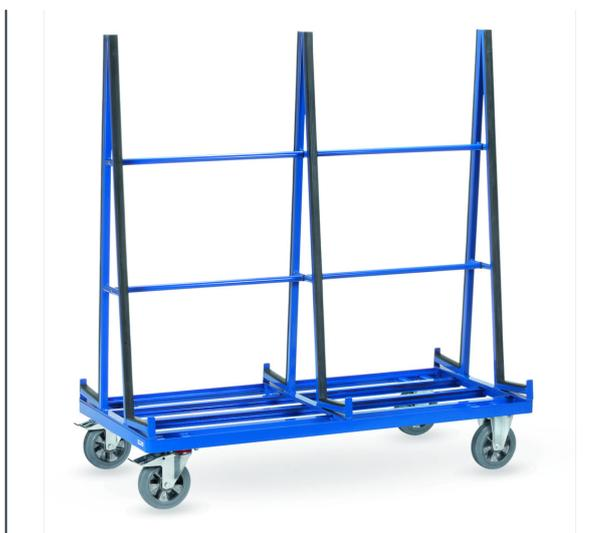
Pour un transport sécurisé des plaques de verres, bois et plastiques, ainsi que portes et fenêtres montées. Ensemble mécano-soudé, revêtement époxy bleu RAL 5007. Chariot à 2 faces avec protection en caoutchouc. 2 roues fixes et 2 roues pivotantes à bandage caoutchouc élastique bleu gris non traçant, moyeu à roulement à billes. Freins sur roues pivotantes. Largeur utile: 2x 230 mm, hauteur utile: 1 450 mm.
