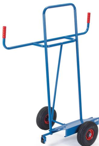
Construction en tube d'acier avec bavette en tôle d'acier, revêtement époxy bleu RAL 5007. Roues à bandage caoutchouc, moyeu à roulement à rouleaux. 2 galets de maintien Ø 50 mm. Pour le transport longitudinal de panneaux en bois et en plastique de grande surface.
