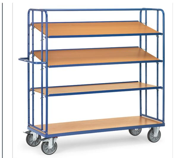
Ensemble mécano-soudé, revêtement époxy bleu RAL 5007. 1 plateau fixe et 3 plateaux amovibles en mélaminé surface effet hêtre avec rebord de 15 mm sur les grands côtés. Plateaux amovibles réglables au pas de 120 mm. Angle d'inclinaison 15° ou 30°. 2 roues pivotantes et 2 roues fixes à bandage TPE, moyeu à roulement à billes central. Freins sur roues pivotantes.
