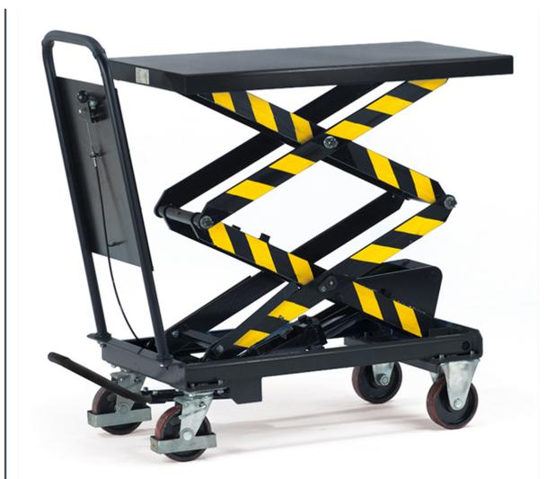
En acier soudé, revêtement époxy Gris Anthracite RAL 7016. Dossier de poussée fixe boulonné, pompe hydraulique à pédale. Double ciseaux pour haute élévation. Vitesse de descente réglable. 2 roues fixes et 2 roues pivotantes à bandage en polyuréthane, moyeu à roulement à billes. Roues pivotantes avec freins.
