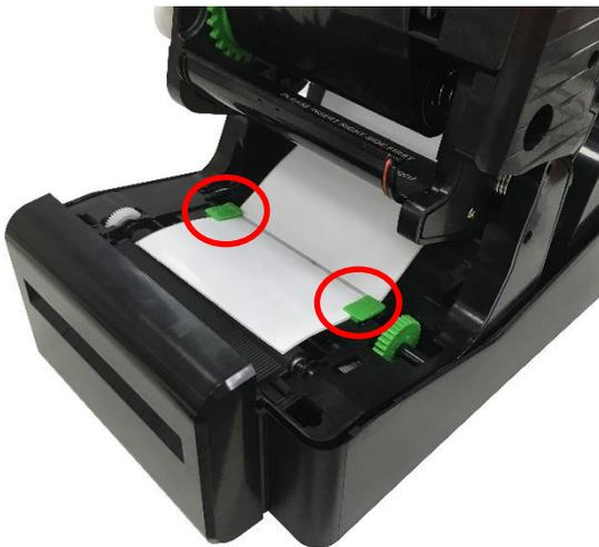
3. Poussez le bouton de libération de la tête d'impression pour ouvrir le mécanisme de la tête d'impression et chargez le consommable via le capteur de consommable. Déplacez les guides papier pour correspondre à la largeur du papier.
