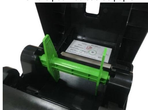
Axe de consommable fixé avec deux pattes de fixation et deux adaptateurs 1,5"
