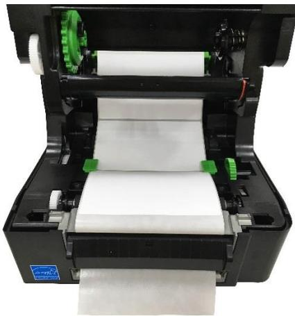
6. Fermez le module de pré-décollage. Utilisez l'“Outil de diagnostic” pour paramétrer le mode de pré-décollage en sélectionnant l'option “PEEL (PRE-DECOLLAGE)” pour le réglage d'action post-impression puis cliquez sur le bouton “Set (Régler)” pour activer le mode de pré-décollage.
