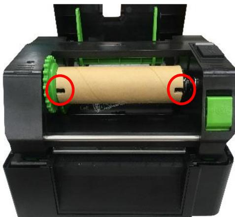
3. Insérez d'abord le côté droit de l'axe de rembobinage du ruban. Puis insérez le côté gauche dans le trou sur le côté gauche du hub de rembobinage du ruban (vert).
