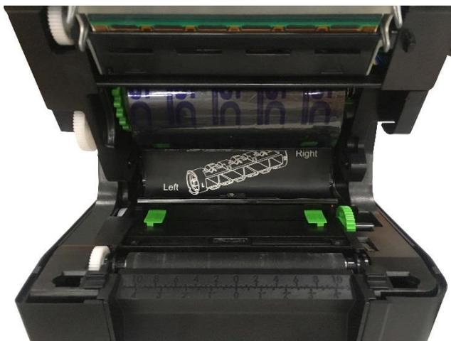
6. Insérez d'abord le côté droit de l'axe d'alimentation du ruban (marqué "D") dans le hub d'alimentation du ruban. Puis insérez le côté gauche de l'axe d'alimentation du ruban dans le trou sur le côté gauche du hub d'alimentation du ruban (vert).
