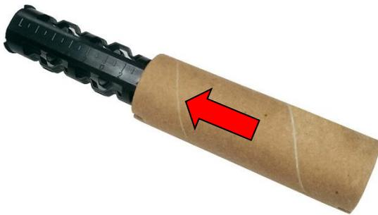
2. Mettez un mandrin papier sur l'axe de rembobinage du film.
