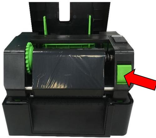
4. Poussez le levier de libération de la tête d'impression pour ouvrir le mécanisme de la tête d'impression.
