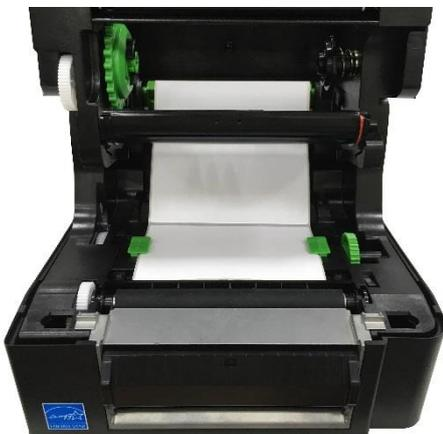
3. Poussez le bouton de libération de la tête d'impression pour ouvrir le mécanisme de la tête d'impression et chargez le consommable via le capteur de consommable. Déplacez les guides papier pour correspondre à la largeur du papier.
